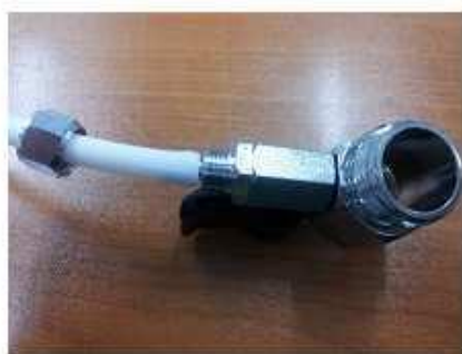
Рис. 2. - Соединение полиуретанового шланга с водопроводным краном
