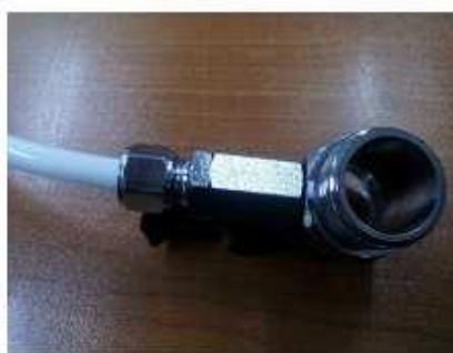
Рис. 2. - Соединение полиуретанового шланга с водопроводным краном
