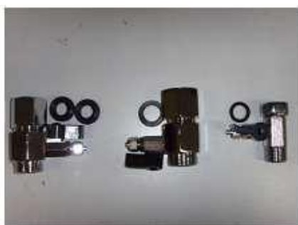
Рис. 2. - Соединение полиуретанового шланга с водопроводным краном
